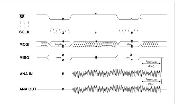
FIGURE 8: PLAYBACK/RECORD AND STOP CYCLE
